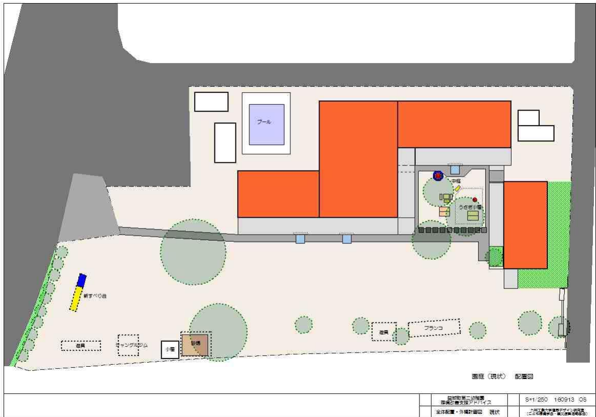
図版2-① 名称：益城町第二幼稚園 環境改善計画提案 2016年9月 説明：全体配置図（園庭現状調査結果プロット）
